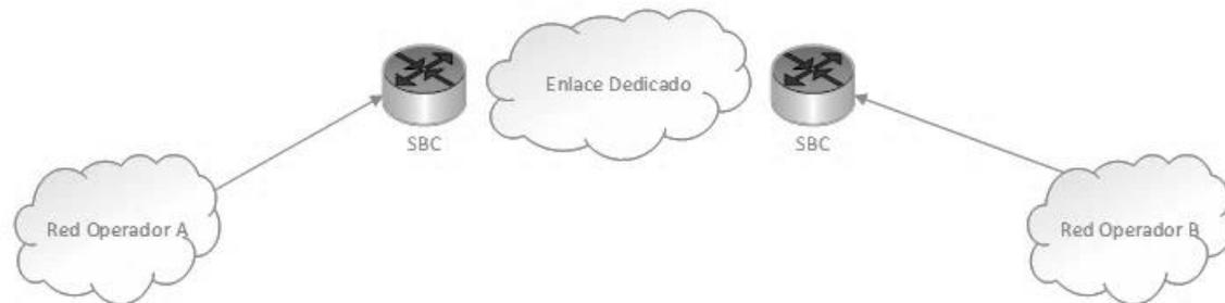
Figura 1. Topología de interconexión SBC-SBC
