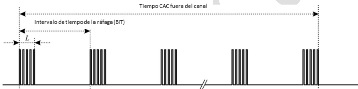
Figura 2E: Estructura general de la señal de prueba de radar de múltiples ráfagas/ basada en paquetes con PRF escalonado.
