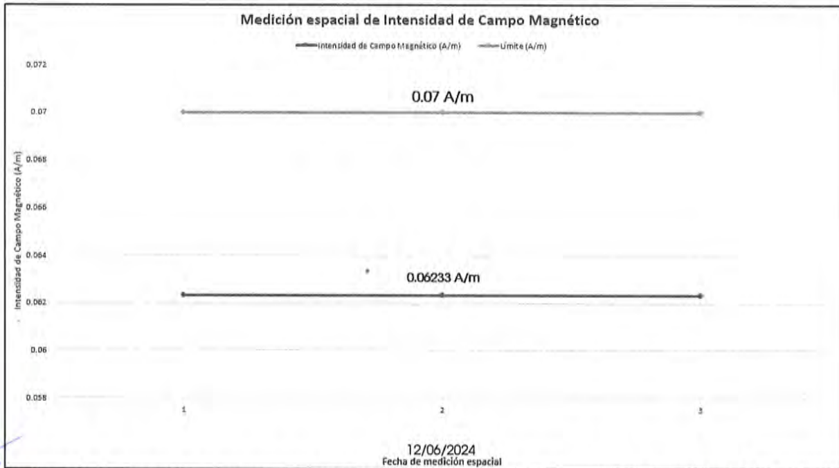
Imagen 8. Comparativo entre el valor espacial obtenido en el punto de medición 23 y el límite para campo magnético 0.073 A/m para exposición poblacional.
