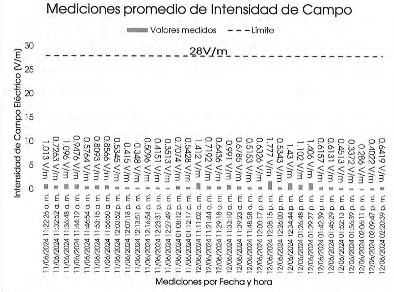
Imagen 4. Comparativo entre el valor promedio obtenido de cada punto indicado en la Tabla 3 y el límite de campo eléctrico de 28 V/m para exposición poblacional.
