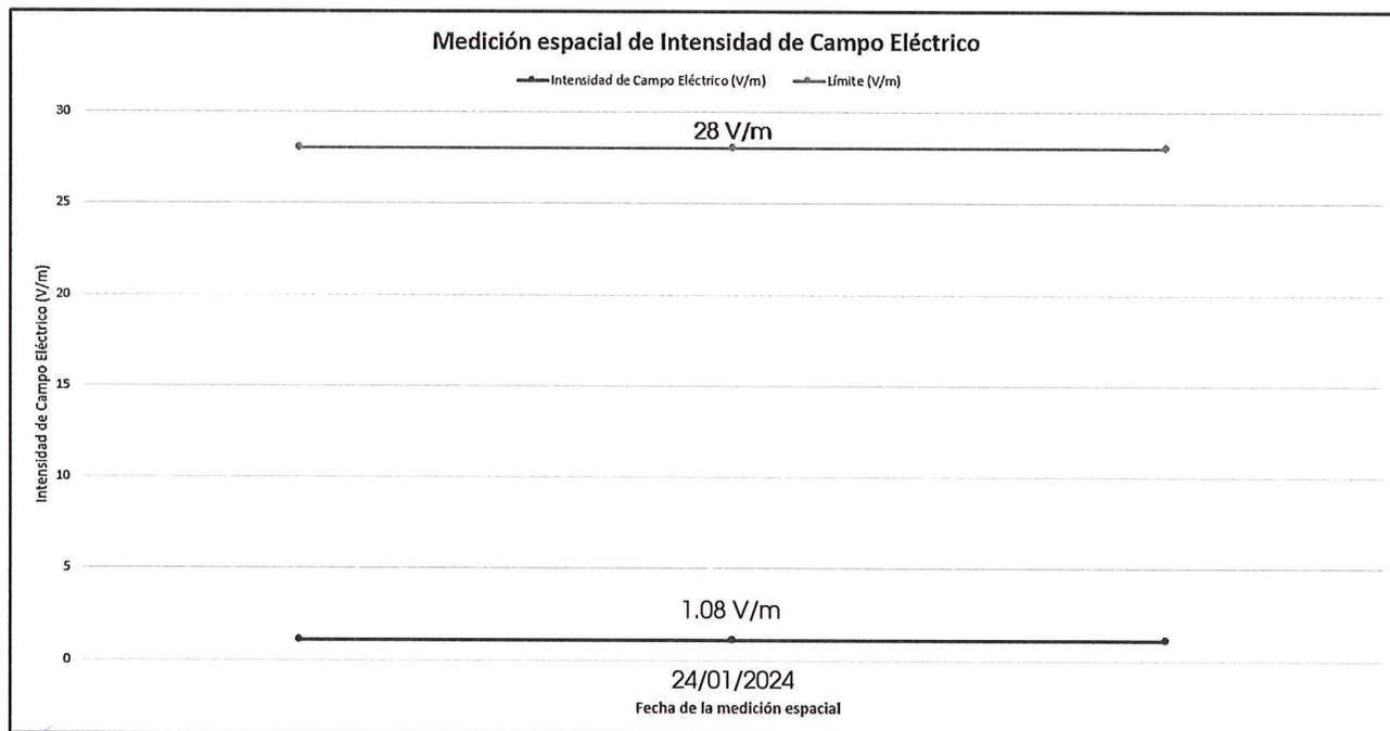
Imagen 22. Comparativo entre el valor espacial obtenido en el punto de medición 1 y el límite para campo eléctrico 28 V/m para exposición poblacional.
