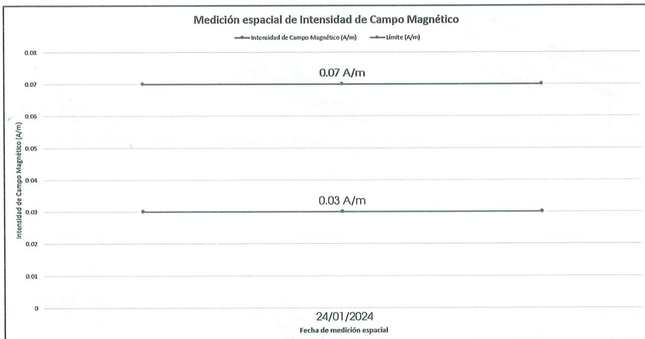
Imagen 23. Comparativo entre el valor espacial obtenido en el punto de medición 1 y el límite para campo magnético 0.073 A/m para exposición poblacional.
