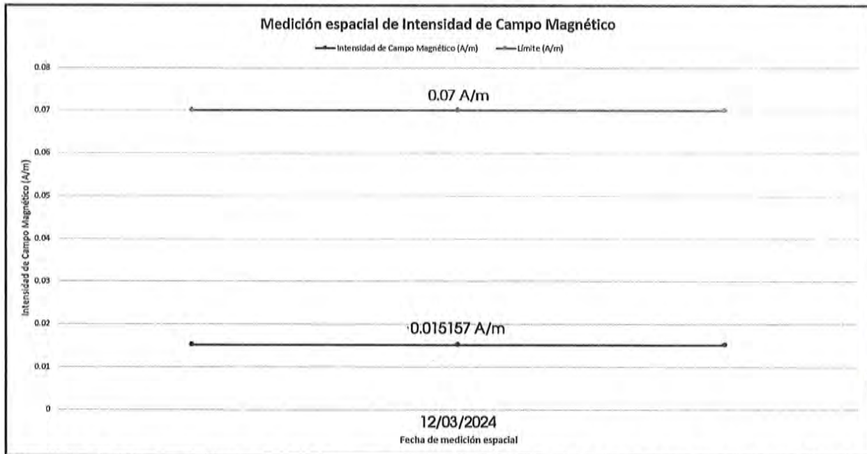
Imagen 20. Comparativo entre el valor espacial obtenido en el punto de medición 10 y el límite para campo magnético 0.073 A/m para exposición poblacional.
