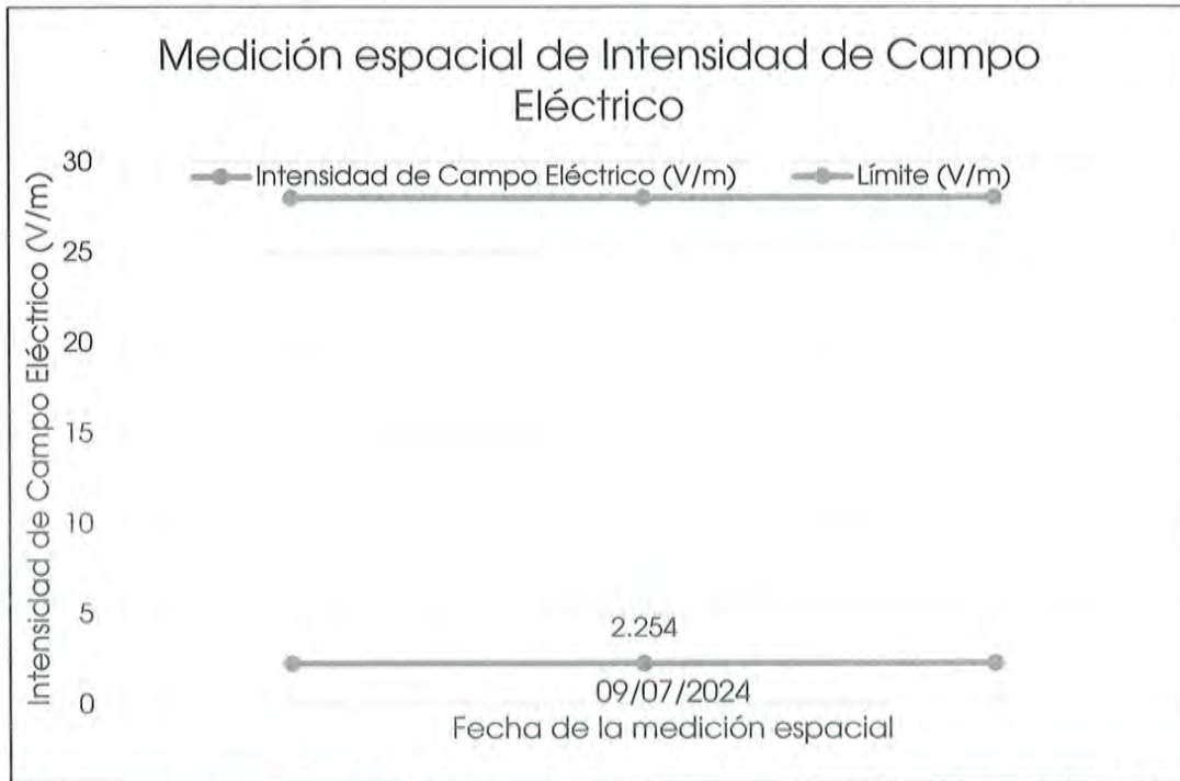
Imagen 7. Comparativo entre el valor espacial obtenido en el punto de medición 45 y el límite para campo eléctrico 28 V/m para exposición poblacional.
