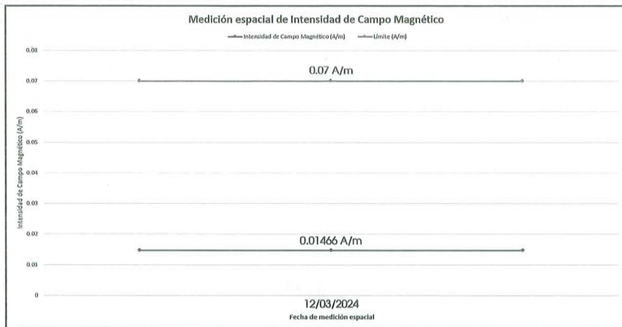
Imagen 21. Comparativo entre el valor espacial obtenido en el punto de medición 1 y el límite para campo magnético 0.073 A/m para exposición poblacional.
