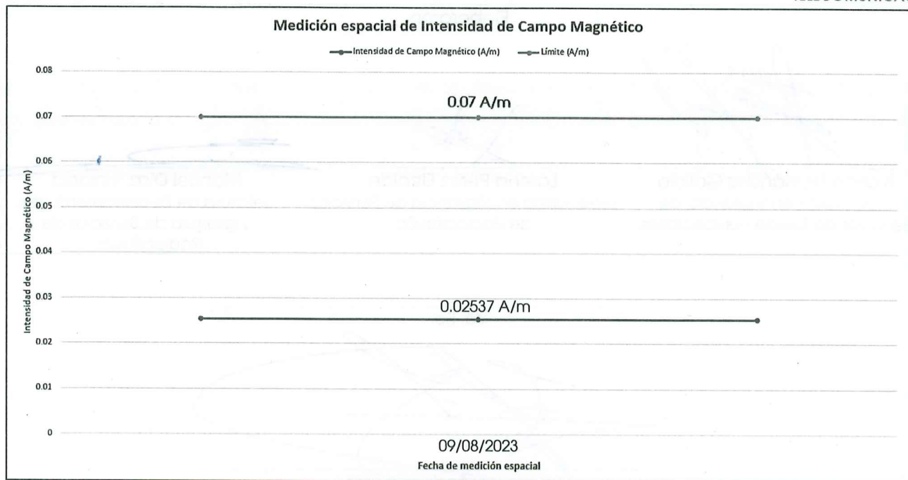
Imagen 22.-Comparativo entre el valor espacial obtenido y el límite para campo magnético 0.07 A/m.
