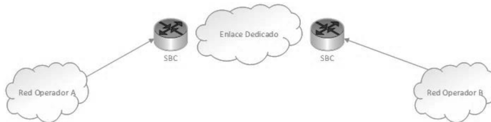
Figura 1. Topología de interconexión SBC-SBC
