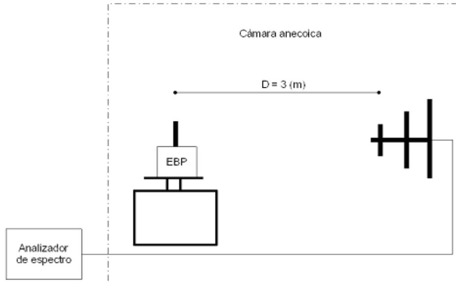
Figura 2. Configuración para medición de emisiones radiadas.
