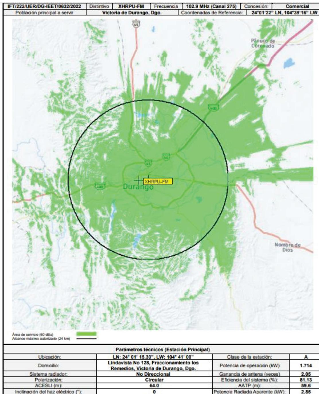
AATP, Altura del centro de radiación de la antena con relación al terreno promedio entre 3 y 16 km, calculada a 72 radiales
