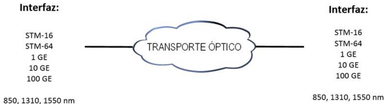
Figura 3 Arquitectura del servicio de canal óptico.
