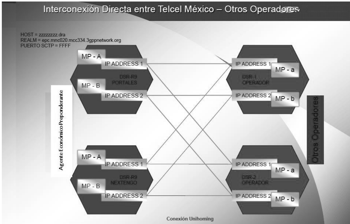
Figura 3: Diagrama de interconexión directa e indirecta vía señalización Diameter mediante interface S6a.
