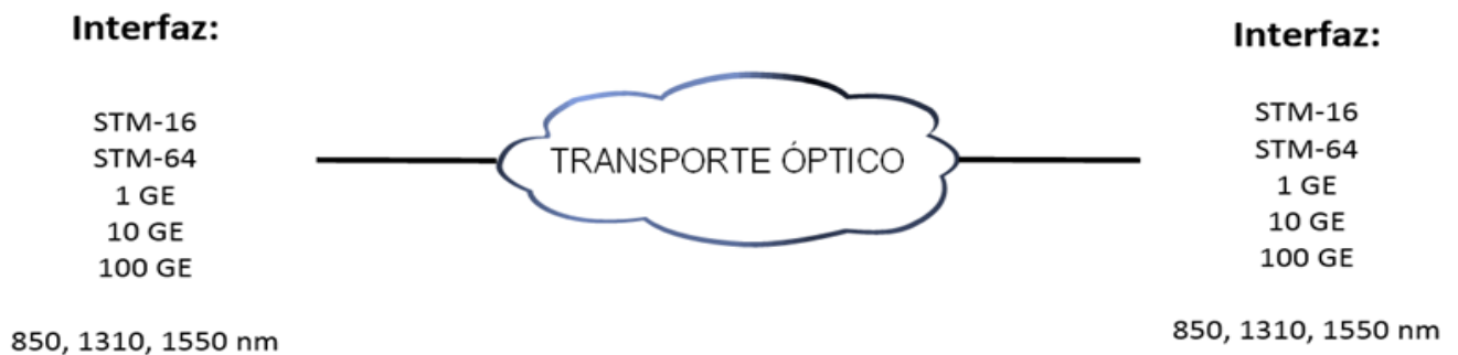
Figura 3 Arquitectura del servicio de canal óptico.
