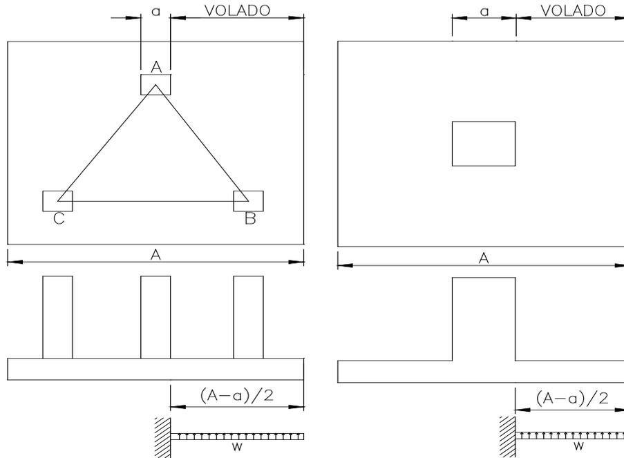
El valor de las presiones de contacto  $q_{\text{diseño}}$  que se utilizarán para el cálculo del momento de diseño será el resultante del  $q_{\text{act}}$  por su factor de carga correspondiente (sin considerar el peso de relleno).
