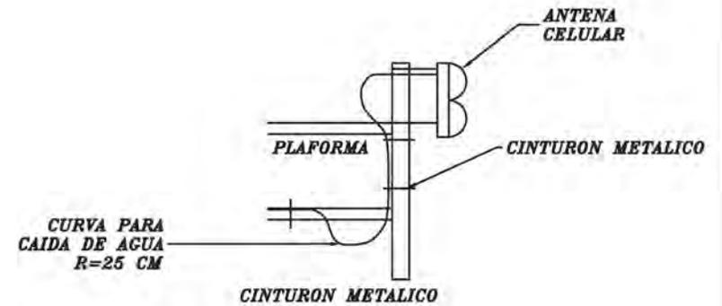
**FIJACION DE FEEDERS Y JUMPER EN PLATAFORMA**
